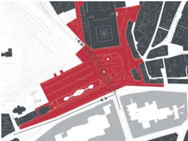
San Clemente|Alameda|Carreira do Conde. Soterramento da vía e ampliación do espazo peonil
